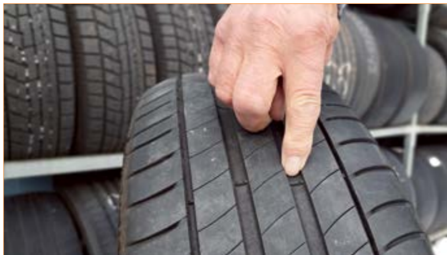
Slitagevarnaren, en liten gummiklack i mönstret, visar när det är dags att byta däck.
